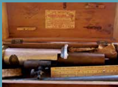
Ebullimètre, appareil de mesure du taux d'alcool, mis au point par Jules Salleron en 1870
