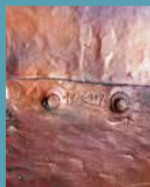
Marque des douanes placée sur la cuve de l'alambic comprenant le numéro du département de fabrication, le poinçon de contrôle et le numéro d'enregistrement
