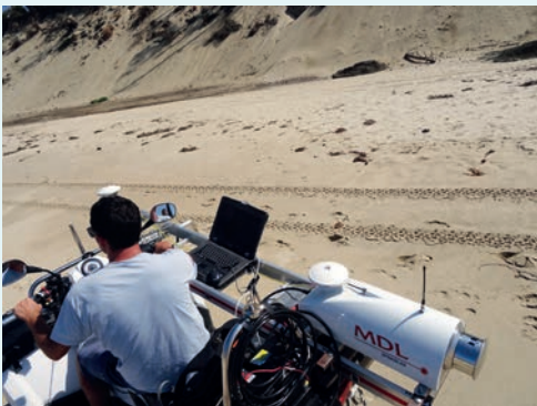
Scanner du cordon dunaire en Quad (Observatoire du littoral de l'île de Ré)
