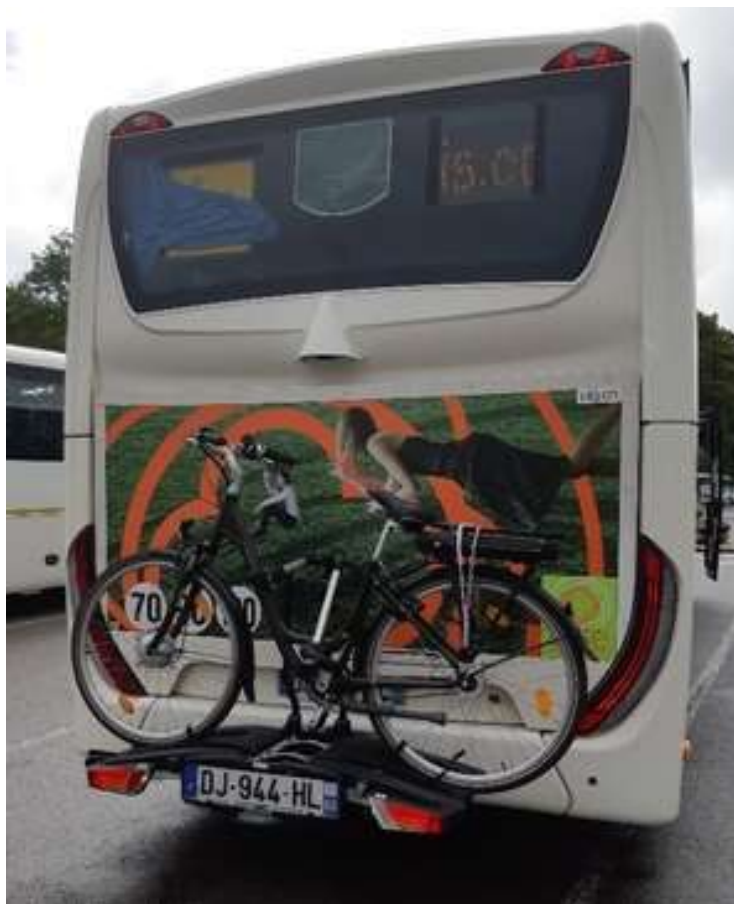
Système de porte-vélos expérimenté par la région hauts-de-France et Kéolis Oise Source : Kéolis Oise
