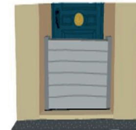
Le batardeau à glissières
