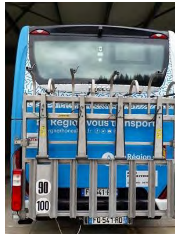
Système de porte-vélos utilisé sur la ligne E12 de la Région Auvergne Rhône-Alpes, exploitée par les Courriers Rhodaniens Source : Galéo
