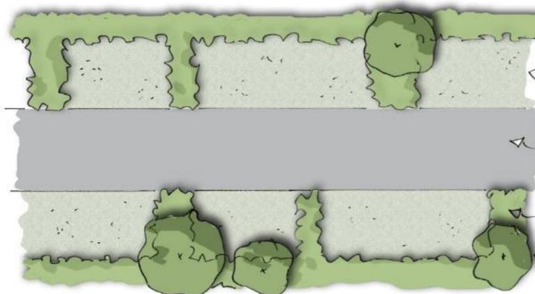
Stationnement organisé par poches (3 à 5 places) en revêtement perméable (terre-pierre enherbée, pavés béton engazonnés...)
