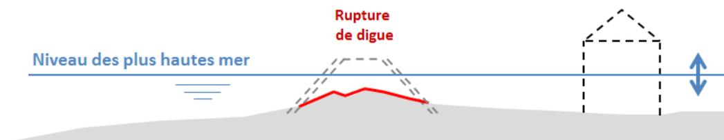
Lors des tempêtes marines, le niveau moyen de la mer augmente sous l'effet conjoint de la dépression atmosphérique et des vents (qui poussent l'eau vers la côte). De plus, l'érosion progressive des cordons dunaires par le vent ou par l'agression de la houle peut provoquer l'apparition de brèches qui menacent les terrains situés en arrière du littoral dont l'altimétrie est en-dessous du niveau atteint par la mer.
