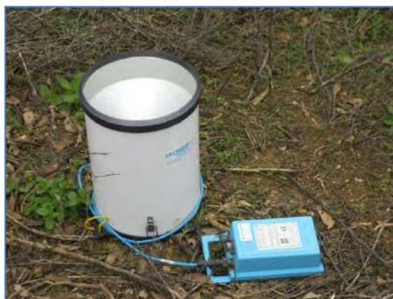
Figure 3 : Pluviomètre à auget basculant
