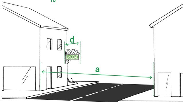
Ne doit pas dépasser la limite supérieure du mur support
